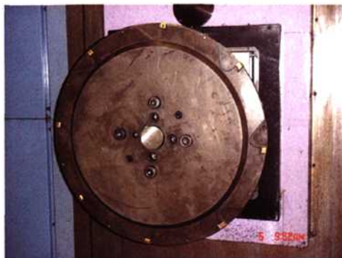
图8 隔板定位面堆焊槽
