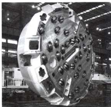
图4 青海双护盾硬岩掘进盾构机刀盘(已安装滚刀)
