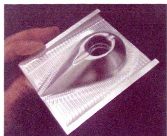
这是引擎盖锁板可见的一面，展现了在FanucRobodrill加工中心上用GibbsCAM编程达到的表面粗糙度
