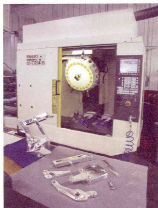
Todd设计了一个引擎盖铰链装置，包括带有平行铣调节扳手的螺丝调节器，它们中的两个被Reactor采用
