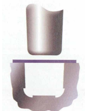
图1 去除模型尖角和小的圆角
