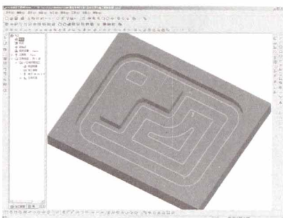
图4 适合高速加工的拐角2
