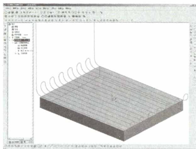
图3 适合高速加工的拐角轨迹1
