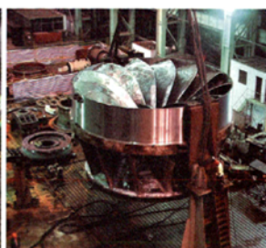
图4 用无接头钢丝绳和翻身架 对转轮进行翻身
