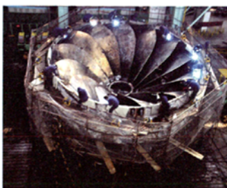
图3 正在焊接的三峡转轮
