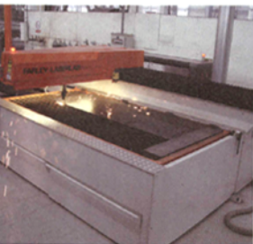
图5 数控激光切割机切割磁轭冲片
