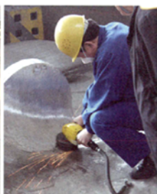
图2 采用涡轮式风动砂轮机 铲磨叶片
