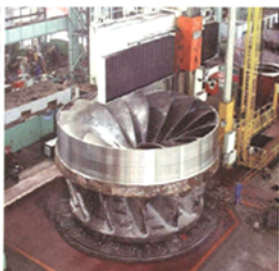
图7 在22m立车上车削三峡转轮
