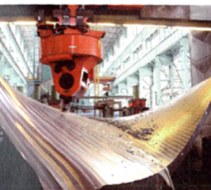
图1 五轴数控天桥铣加工三峡叶片
