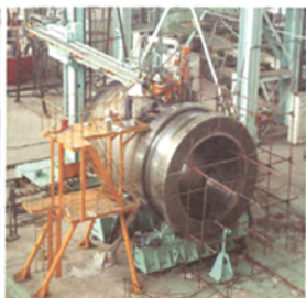
图6 窄间隙自动焊机焊接三峡主轴
