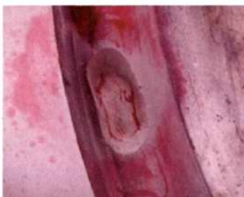
图3 T形槽底部轻微裂纹
