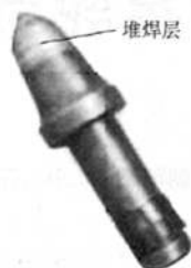
图 4 等离子弧耐磨堆焊层
