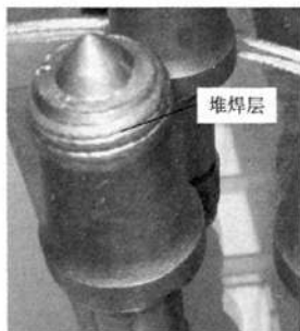
图3 截齿耐磨堆焊层
