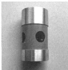
图2 零件外圆包括原始面和铬酸阳极化表面
