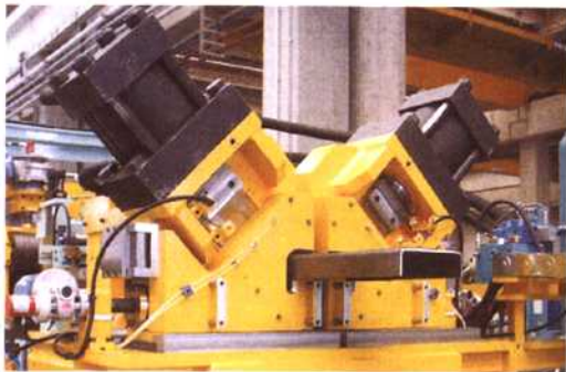
图4 压力机与模具一体跟踪切断单元
