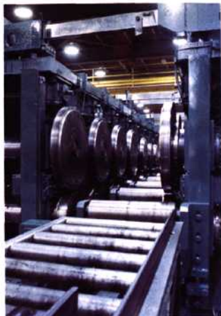
图3 开式辊压成形单元
