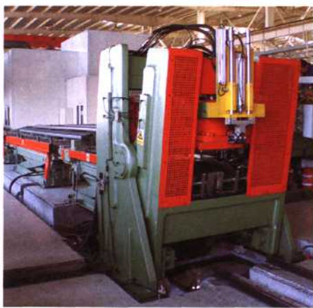
图7 折弯机和送料单元
