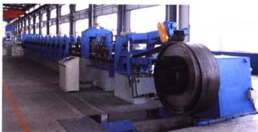
图1 辊压成形生产线
