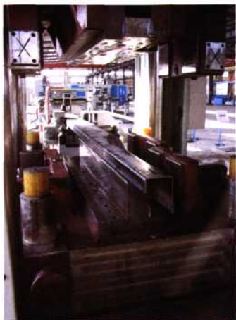
图9 正被送出压力机的变截面纵梁
