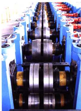
图2 闭式辊压成形单元
