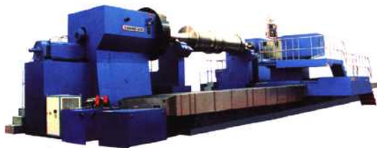
图2 数控重型卧式车床
