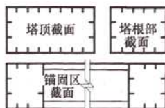
图6 郑州黄河公铁两用大桥钢塔柱
