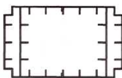
图2 泰州长江大桥钢塔上塔柱
