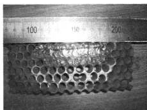
图9 集中修复后的焊缝表面
