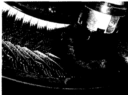
图7 正在放电加工雪地轮胎模具
