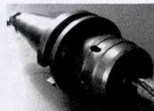
图4 弹性夹紧式BT刀柄
