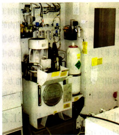
液压系统采用蓄能器的Starragheckert公司HEC1600卧式加工中心
