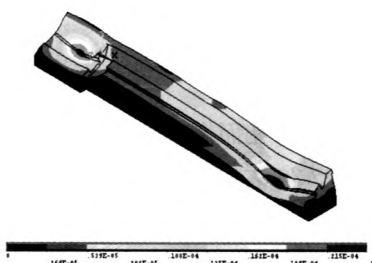
图13 增加床身竖向筋板后的变形结果
