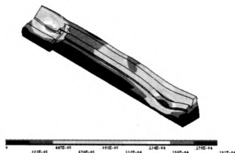
图7 改变筋板间隔距离后的变形结果
