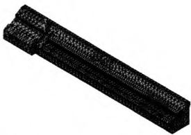
图2 床身模态分析三维有限元模型
