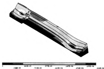
图11 增加床身竖向筋板后的变形结果
