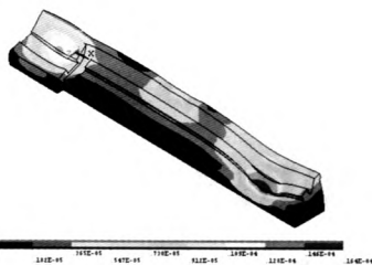
图9 增加床头竖向筋板后的变形结果
