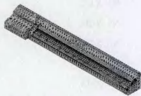
图2 床身模态分析三维有限元模型
