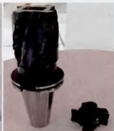
图4 株钻的高效螺旋立铣刀
