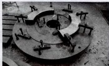
图3 喷嘴组车加工夹具实物
