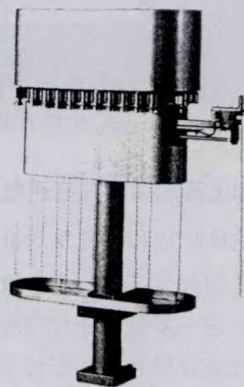
图16 电极自动交换装置（ESF 24）
