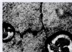
图4 2 # 位置焊缝中的夹渣及裂纹 100×
