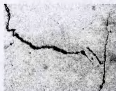
图5 2 # 位置焊缝中的裂纹尖端形貌 100×
