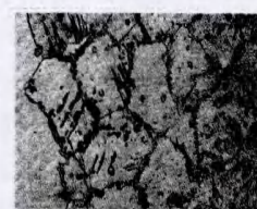
铁素体+ \sigma 相+颗粒状碳化物 图8 2 # 位置热影响区 100×
