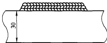
图2 工艺评定焊接接头简图
