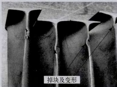
图1 火焰筒故障形态
