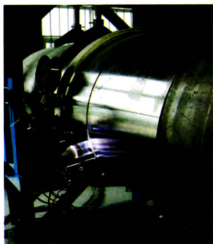
图11 窄间隙TIG焊
