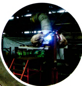
自动焊接管件 与法兰角焊缝
