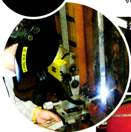
气体保护焊与自动焊相结合
