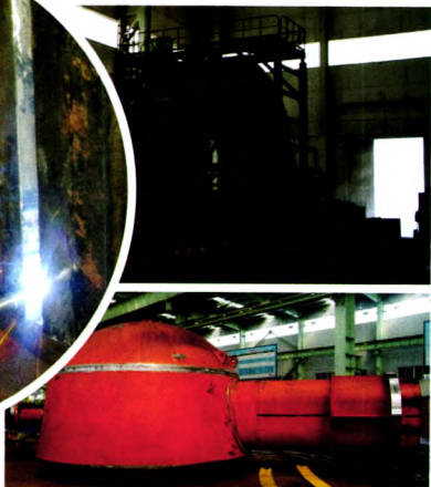
复合板泡头焊接
