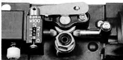
图2 新型的焊枪拉丝系统
