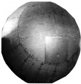
图1 球形封头焊缝布置
