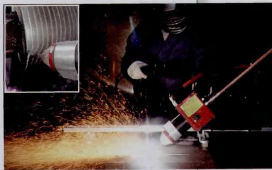
图9 维克多数字自动化碳弧气刨系统
