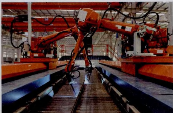
图1 ABB波纹腹板H型钢焊接技术
