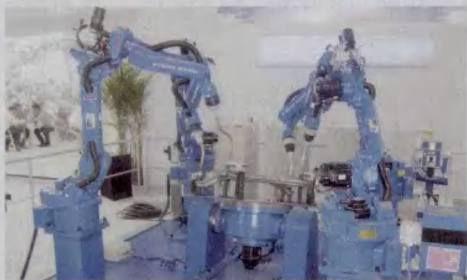
图2 四机器人焊接工作站
