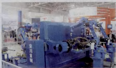
图3 双工位自动上下料焊接工作站
