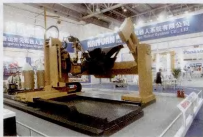
图1 挖掘机下车架双丝焊接机器人系统
