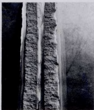
图 1 纯氩保护气施焊工件
