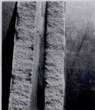
图 2 混合保护气施焊工件
