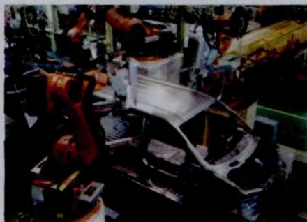
机器人焊接现场
