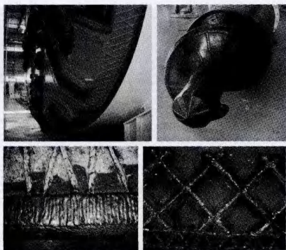
盾构机关键部件及堆焊形貌
