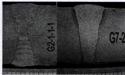
图6 混合焊宏观照片
