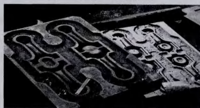
(b) 一模两件连杆两型腔锻模
