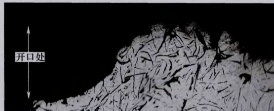
图4 气缩孔剖面部分孔壁的形貌
