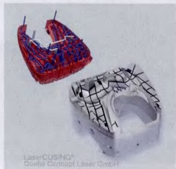
图7 生产带冷却管吸尘器盖的使用工具
