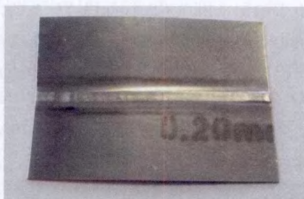
图11 采用15 000 Hz超高频脉冲焊接的0.2mm厚度 不锈钢零件
