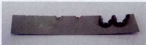
图12 采用DC超高频脉冲焊接0.2mm厚的钢板
