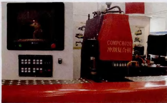
图3 采用如冈自控数控系统TNC2000D的冲切复合机 适用于中厚板冲切复合加工的典型复合机主要性能指标如表1所示。
