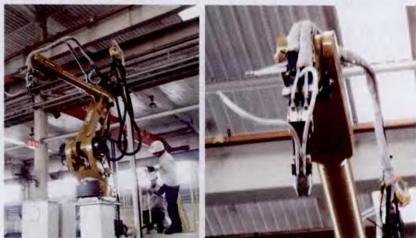
图2 双丝机器人的双丝焊枪
