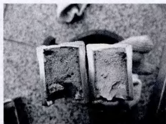
(e) 焊后350℃×2h消氢处理刻槽锤断试验
