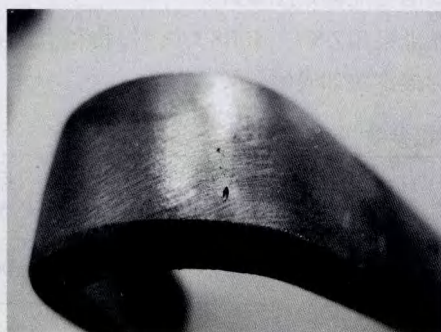
图3 焊条电弧焊弯曲试样出现的裂纹
