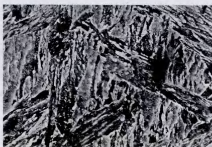
图6 裂纹部位的显微组织电镜照片
