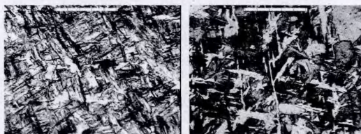
图3 裂纹两边的显微组织照片400×
