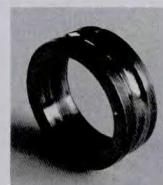
(d) 内圈端面及内径磨损形貌
