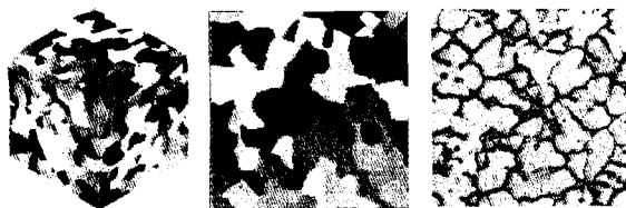
图2 模拟金属型及砂型铸造铝合金的微观组织
