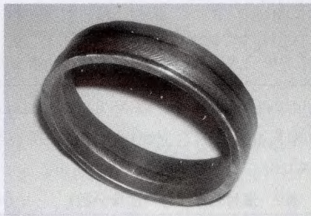
图2 焊缝外观形貌
