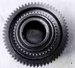
(a) 一档从动齿轮组件焊接（齿圈与一档齿轮焊接）
