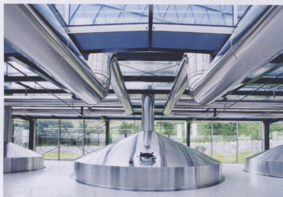
图 3 单个驱动装置驱动过滤工艺，同时松动废酒糟并将其清出发酵桶。减速机与工业齿轮箱相结合后可实现高达 96\,000\text{ N}\cdot\text{m} 的扭矩。
