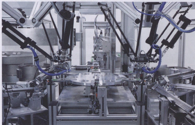
图 3 能效最佳的解决方案往往是电缸和气缸技术的组合
